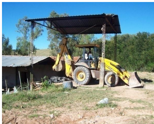
Figura 42: Máquina utilizada no recobrimento diário dos resíduos – (2013).
